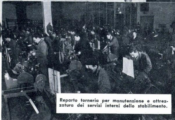
Reparto torneria per manutenzione e attrezzatura dei servizi interni dello stabilimento.
