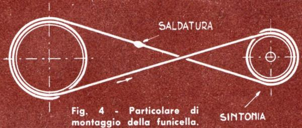
Fig. 4 - Particolare di montaggio della funicella.
