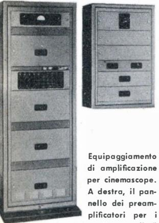
Equipaggiamento di amplificazione per cinemascope. A destra, il pannello dei preamplificatori per i quattro canali di registrazione magnetica, ed a sinistra vediamo il pannello degli amplificatori di potenza.
