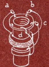
Fig. 5 - Capicorda della bobina dell'oscillatore.
