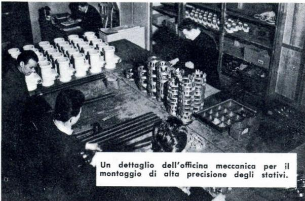
Un dettaglio dell'officina meccanica per il montaggio di alta precisione degli stativi.
